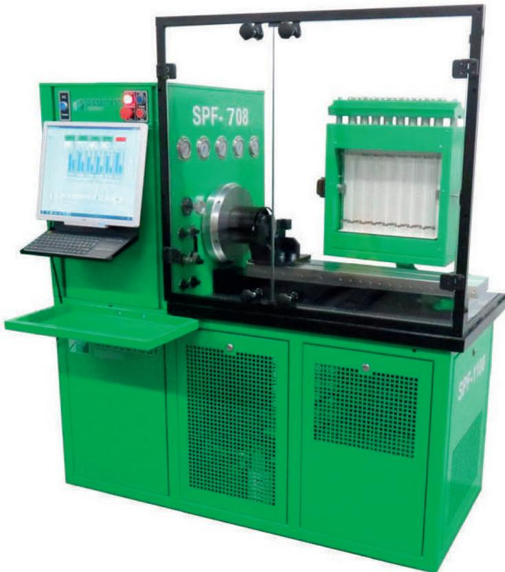
Стенд **SPF-708** предназначен для испытаний и регулировки устройств системы питания дизельных двигателей при проведении их ремонтов и техническом обслуживании.
